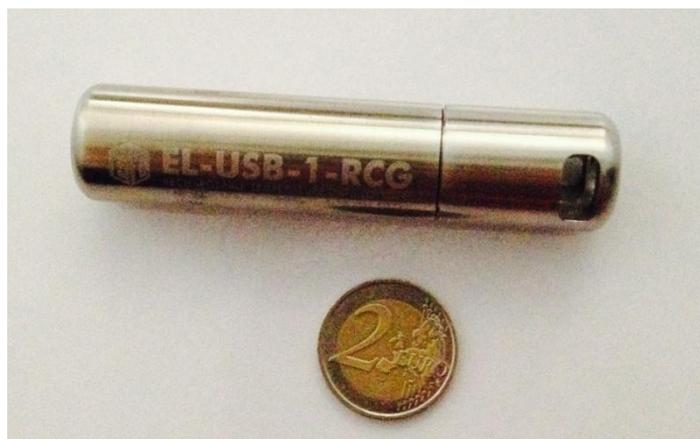
Figure 17: Enregistreur de température EL-USB-1-RGC-JM
