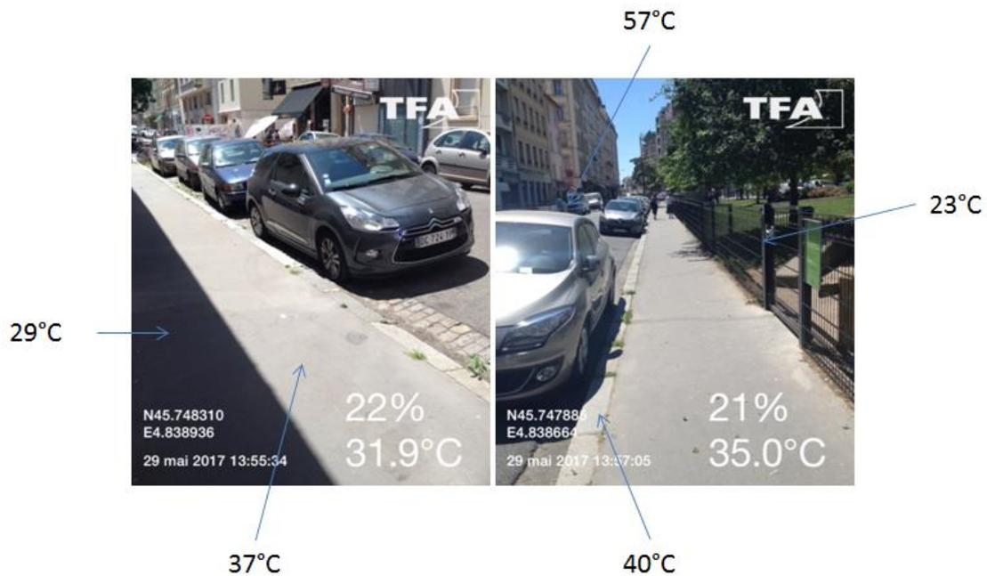
Figure 14: Différentes températures de surface (°C) suivant le revêtement ou l'exposition au soleil
