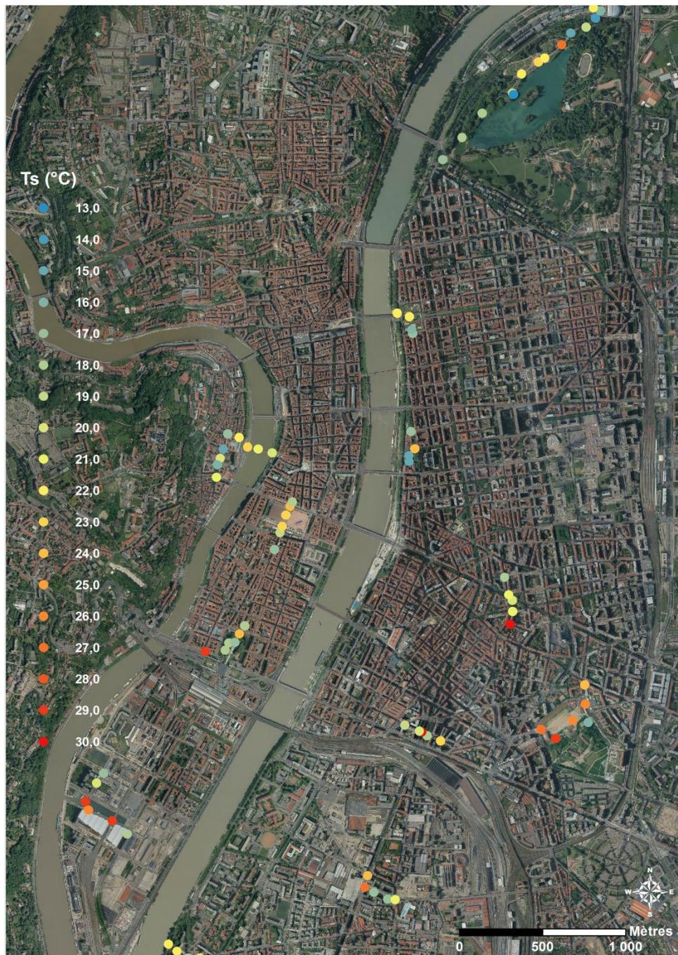
Figure 42: Températures du sol (°C) acquises grâce au dispositif HVAC le 11 avril 2017 entre 10h30 et 12h30 – source Data Grand Lyon
