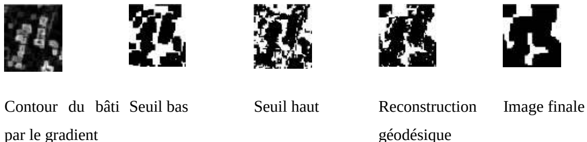
Figure 5.2. Effet du gradient morphologique et de la reconstruction géodésique sur un détail de l'image
