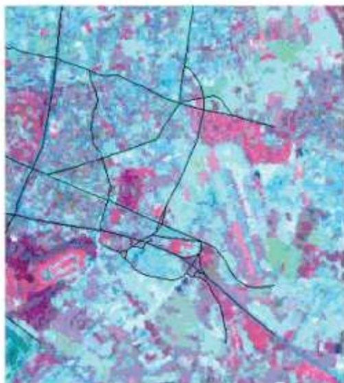
Figure 4.13 : Superposition des routes à une composition colorée réalisée à partir des bandes spectrales rectifiées de l'image Landsat ETM.
