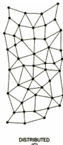
Fig. 10 : réseau distribué. Diagramme original de Paul Baran in Memorandum RM-3420-PR, août 1964, p. 2.
