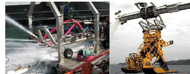
Figure 4 : Trancher de type « jet sledge » (à gauche) et Charrue tractée (à droite) (Orange Marine)
