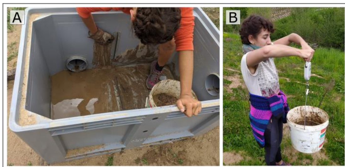
Figure 6-12 : Illustrations du protocole de mesure des sédiments grossiers. A – Curage du collecteur de sédiments. B – Pesée des sédiments collectés.
